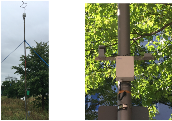
Abbildung 5. links: Traditionelle Klimastation am Helmholtz-Zentrum für Umweltforschung (UFZ), rechts: Messsysteme an Stadtbeleuchtungen
